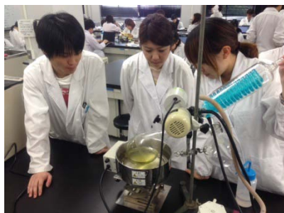
抽出した成分をエバポレーターで濃縮している様子。B3 の学生二人を前に、先輩らしく指導を行う池崎大志(B4、左端)。
